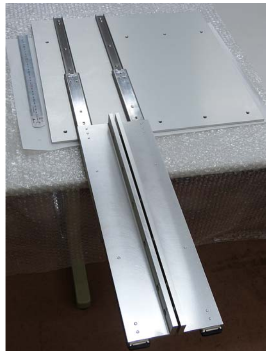
図3 左は棚板の組み上げ図の上面図（使用部品を全て記入している）。右は棚板にレールとジグを取り付けたところ。二つのジグで回路盤を支える。
