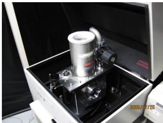
冷えているとき UV-3100 に入れた状態。測定時はこの上から暗幕をかけ、測定ブース内とその外の実験室の照明も消した。
